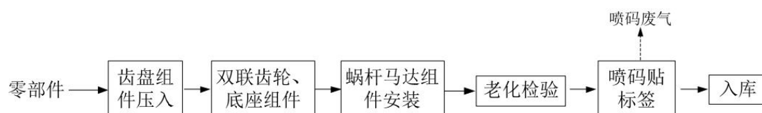
汽车调节器装配生产工艺流程
